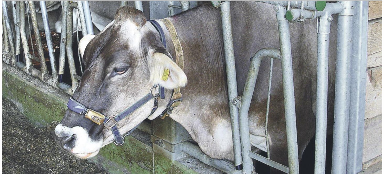
Kuh mit Nasenbandsensor: Damit werden die Bewegungen des Flotzmauls im zeitlichen Verlauf mittels Drucksensoren am Nasenband erfasst. (Bild hf)
